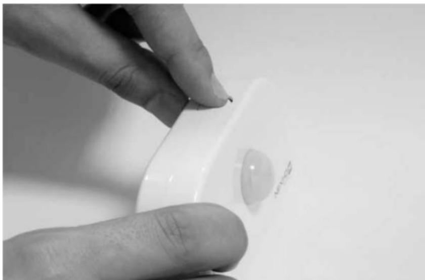
Pour installer le détecteur dans un coin, placez l'élément de montage conçu pour les coins (inclus dans l'emballage du dispositif) dans son emplacement. Utilisez un crayon pour marquer l'emplacement des vis de fixation.
